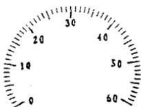
图 2 圆形标度(整圆形或大于 180°的部分圆形)
